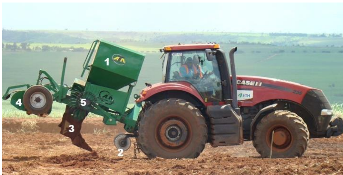
Figura 18 - Implemento canterizador para espaçamento 1,50 m entre linhas de cana-de-açúcar acoplado a um trator. 1 - Depósito para 2.000 kg de corretivos; 2 - Segas circulares; 3 - Haste subsoladora com duto para saída de corretivos; 4 – rodas para controle de profundidade para enxada rotativa; 5 – ancinho para colocar palha na direção da rotativa.
