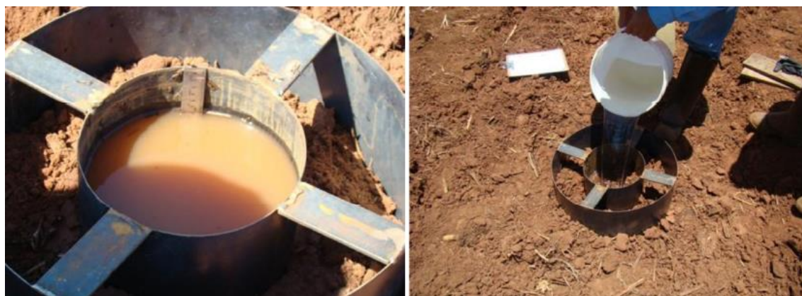
Figura 42 – Avaliação de taxa de infiltração
