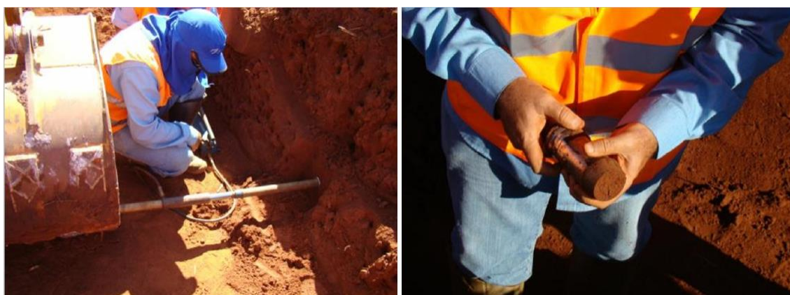
Figura 41 - Sonda hidráulica coletando amostra para análise de densidade
