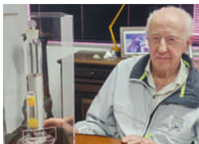
Luiz Antônio e o Densímetro Termo Compensado, sua invenção para garantir a qualidade do etanol
